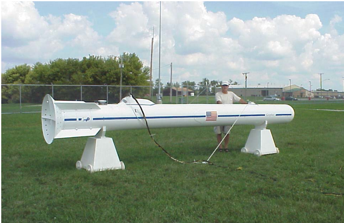
Figure 2 : GEM-2A helicopter-borne EM system
