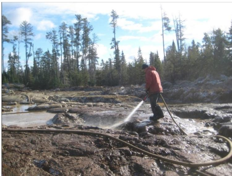
**Photo 4 : Nettoyage d'un affleurement dans la zone décapée.**
