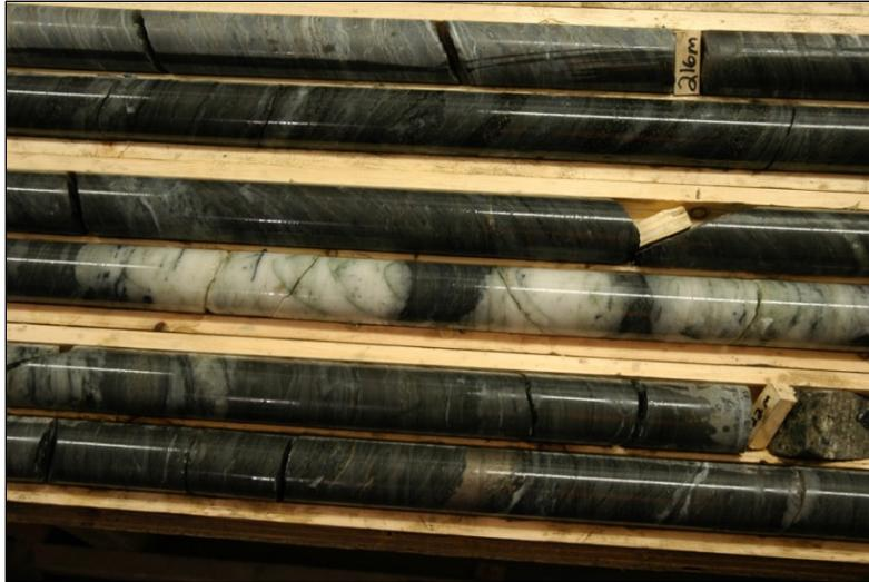
**Photo 9 : Des carottes dans des caisses. Les balises indiquent la distance dans le trou.**
