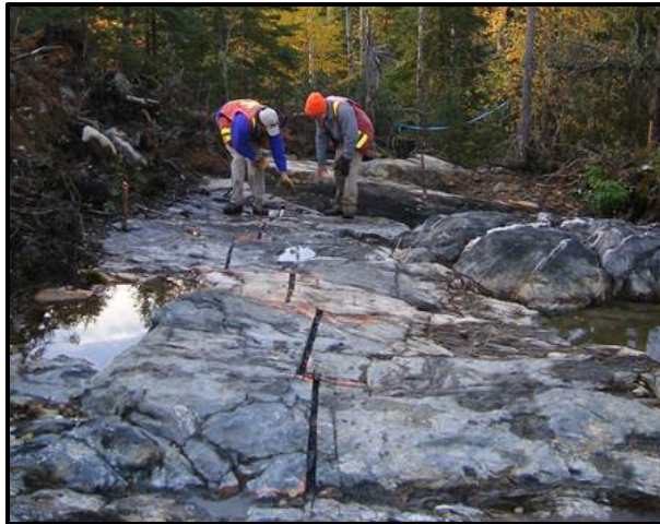
Photo 4 : Petite zone de moins de 100 mètres carrés décapée, nettoyée et échantillonnée.
