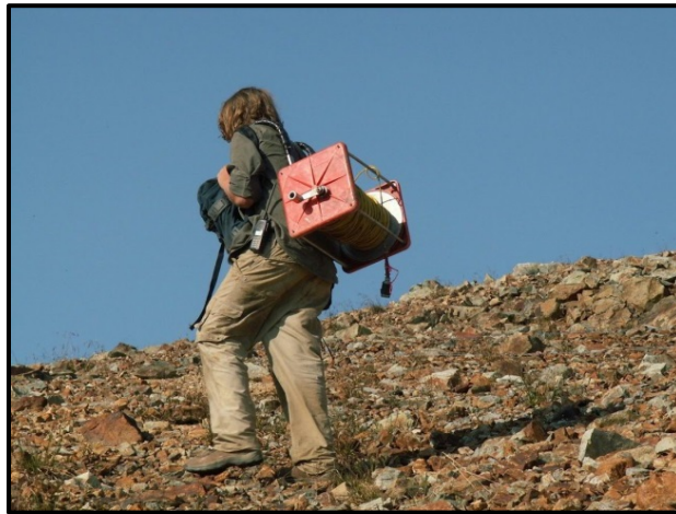
Photo 3 : Un technicien installe du fil en vue d'un levé de polarisation provoquée (PP).
