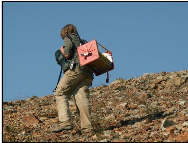
Photo 3 : Un technicien installe du fil en vue d'un levé de polarisation provoquée (PP).
